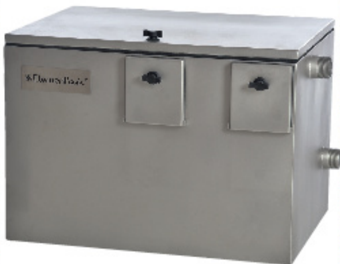
Bac à graisse sous plonge 35 L Siphon intégré. Galet de traitement biologique. Dim. : L. 38 x P.45 x H. 38 cm. Structure : inox AISI 304. Capacité de traitement : +/- 50 repas par jour. Réf. : 1798776
